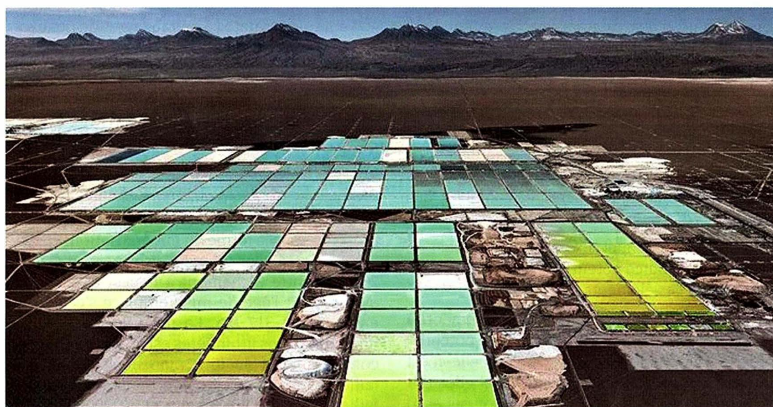
Fig. 2-11. – Vue aérienne des bassins d'évaporation du site de production de SQM, à partir des saumures présentes dans le désert d'Atacama (Chili)
